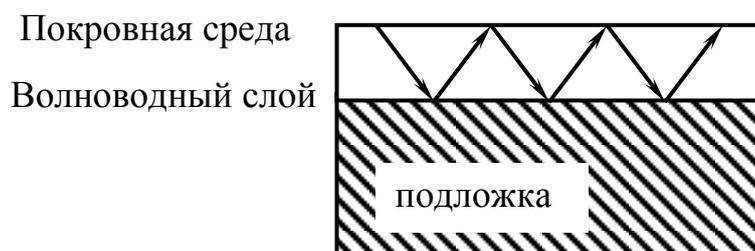
Рисунок 2.1 - Планарный оптический волновод
