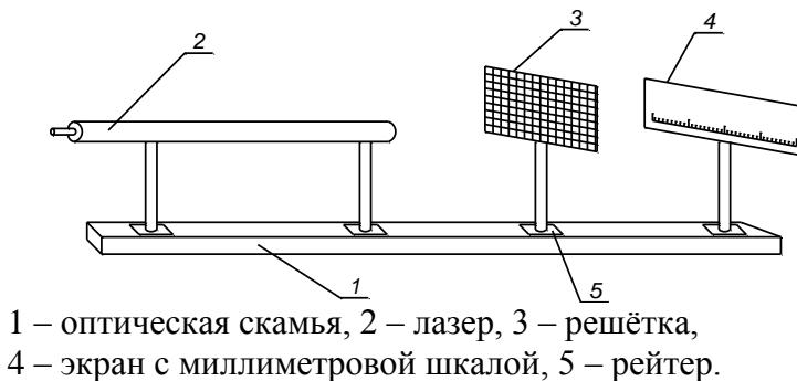
Рисунок 2.1 – Схема экспериментальной установки
