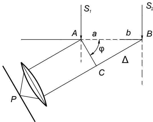
Рисунок 1.2 – К расчёту оптической разности хода
