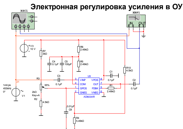
Рис. 2. Схема усилителя с ручной электронной регулировкой усиления.
