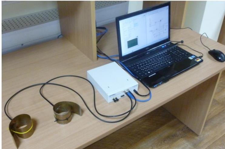
Рис. 1. Прототип системы связи с АМ модуляцией на основе NI USRP-2920
