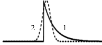
Рис. 2. Форма сигнального тока ЛФД в режиме счета фотонов (1) и гауссова аппроксимация импульсной характеристики ЛФД (2)
