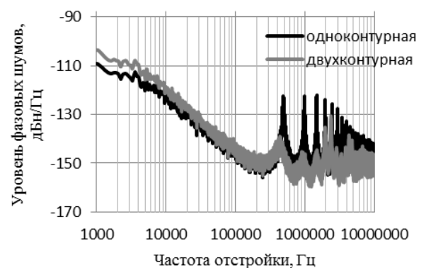
Рис.4. Односторонняя спектральная плотность мощности фазовых шумов L(f)
