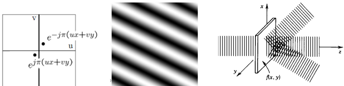
Рис.3. Дифракционная гармоническая решетка и ее пространственный спектр
