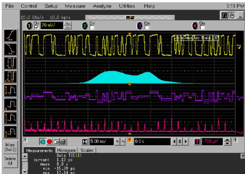
Рисунок 5.18 – Осциллограмма сигнала (желтая кривая), тренд джиттера (фиолетовая кривая), спектр джиттера (малиновая кривая) и гистограмма джиттера (голубая кривая)
