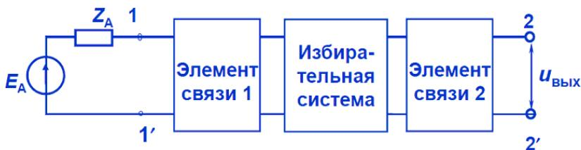
Рисунок 3.6 – Структурная схема входной цепи
