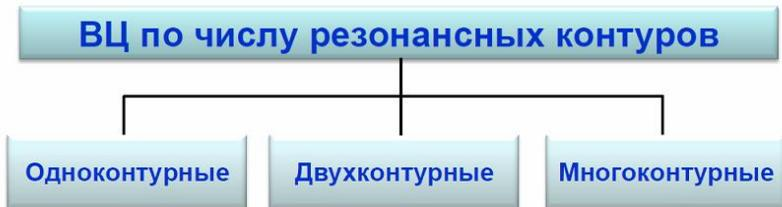
Рисунок 3.9 – Классификация входных цепей по числу резонансных контуров
