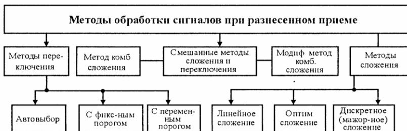
Рисунок 7.2 – Методы комбинирования сигналов при разнесенном приеме
