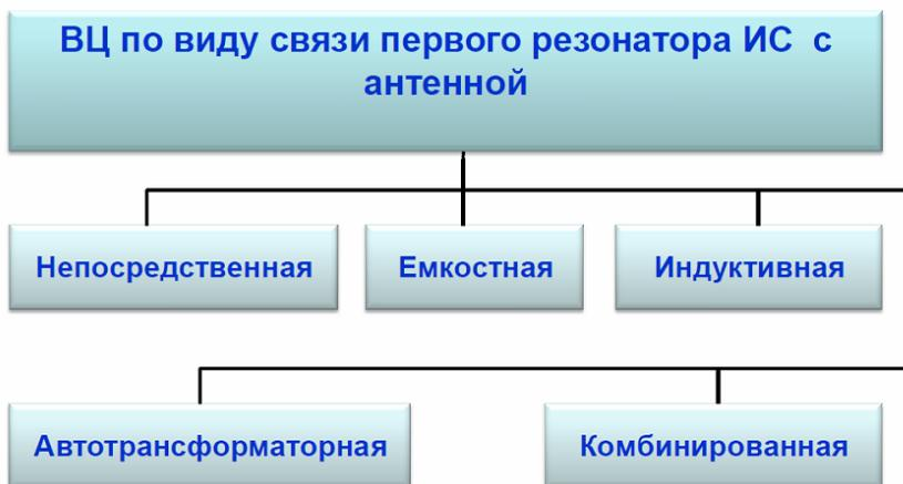
Рисунок 3.7 – Классификация входных цепей по виду связи первого резонатора избирательной системы с антенной
