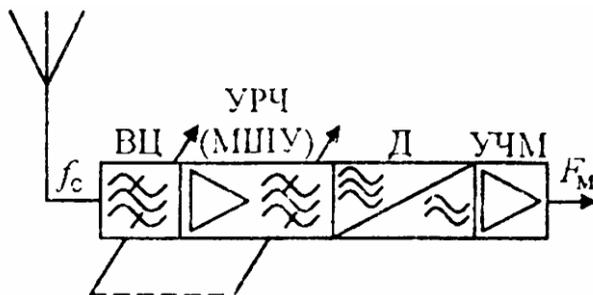
Рисунок 2.3 – Структурная схема приемника прямого усиления: ВЦ – входная цепь; УРЧ – усилитель радиочастоты (малошумящий усилитель); Д – детектор; УЧМ – усилитель частоты модуляции
