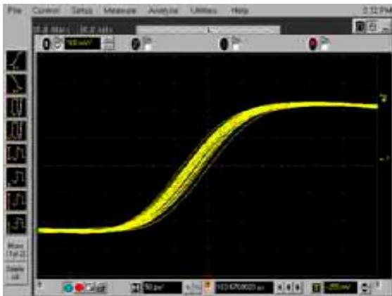
Рисунок 5.17 – Дрожание фронта импульса – джиттер
