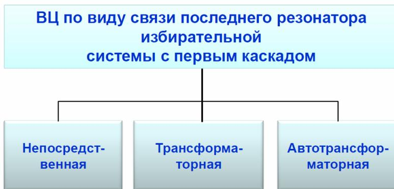
Рисунок 3.8 – Классификация входных цепей по виду связи последнего резонатора избирательной системы с первым усилительным каскадом
