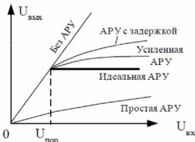
Рисунок 4.4 – Амплитудные характеристики различных систем АРУ
