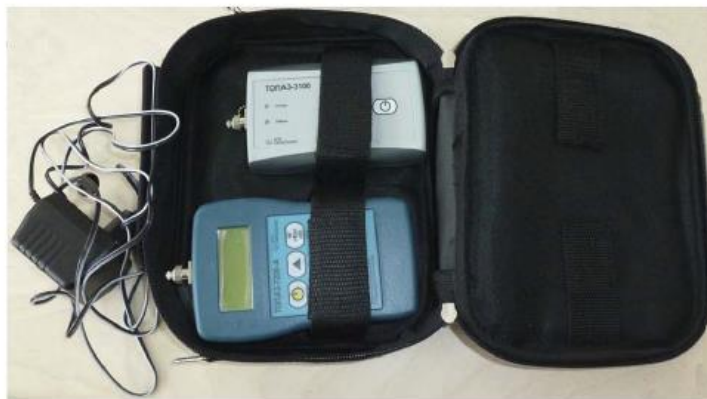
Рисунок 3.6 – Кейс с источником оптического излучения «Топаз 3105», измерителем оптической мощности «Топаз 7210А» и блоком питания «Топаз 7210А»
