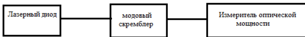
Рисунок 3.3 – Схема измерения ватт – амперной характеристики лазерного диода
