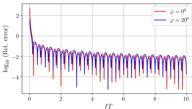
Рис. 4 Зависимость относительной ошибки аппроксимации скалярного произведения двух радиоимпульсов от нормированной несущей частоты. Разность фаз между импульсами —  $\varphi$
