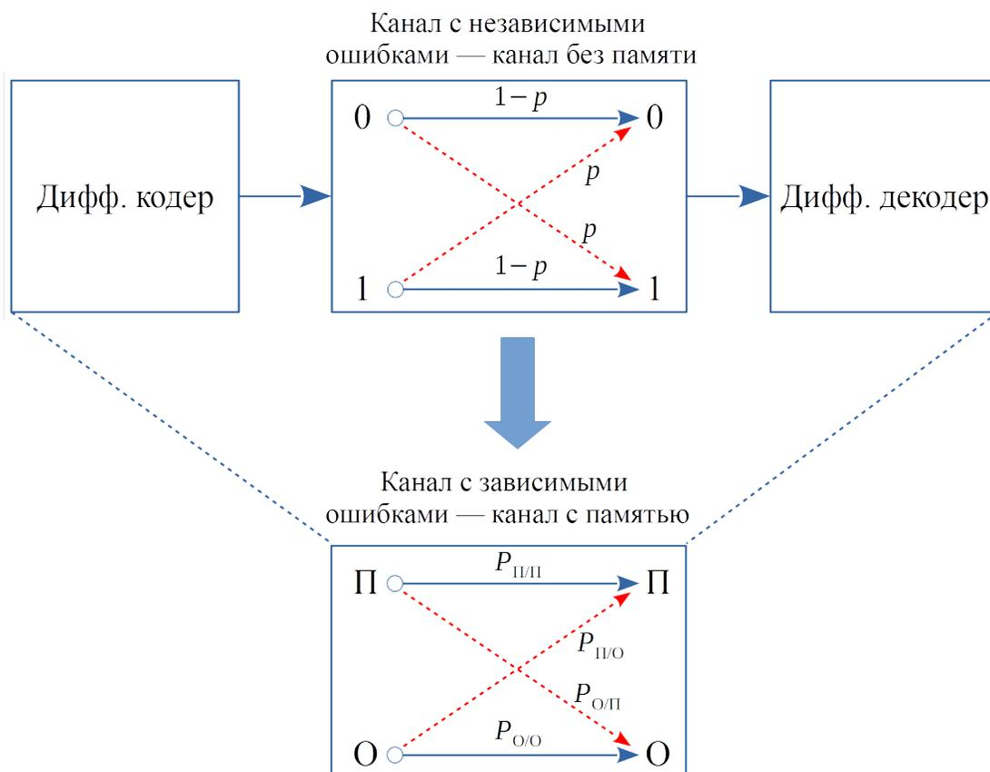
Рис. 3 Эквивалентная замена дифференциального кодера, канала без памяти и дифференциального декодера на новый канал — канал с памятью
