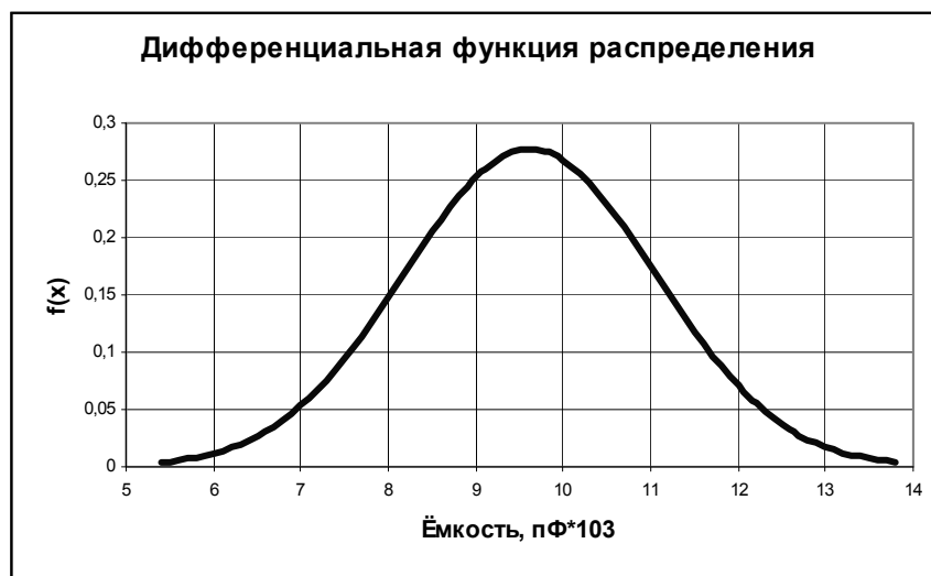
Рис. 1.3. Дифференциальная функция распределения ёмкости пластин пьезоэлементов
