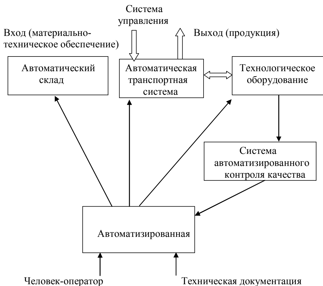
Рис. 6.1 — Состав гибкой производственной системы
