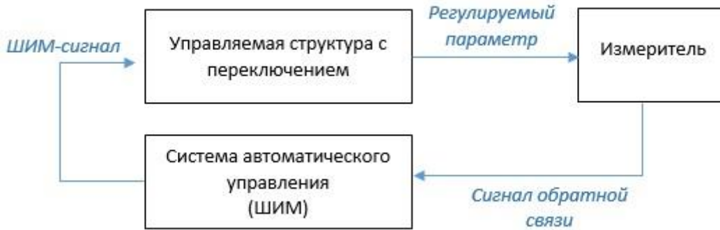
Рис. 26 – Система автоматического управления с ШИМ
