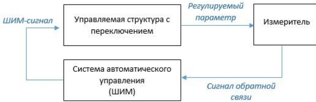
Рис. 30 – Система автоматического управления с ШИМ
