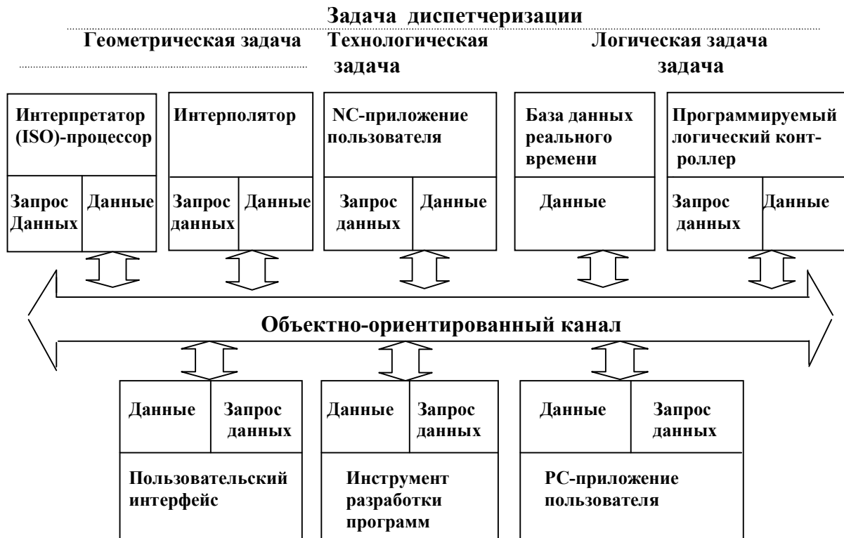
Рис. 9.1 — Модульная архитектура ЧПУ типа PCNC и задачи управления
