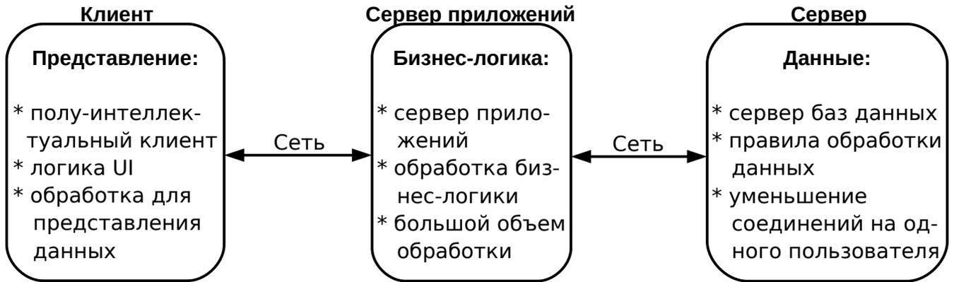
Рисунок 4.2 — Трехзвенная архитектура «Клиент-сервер»
