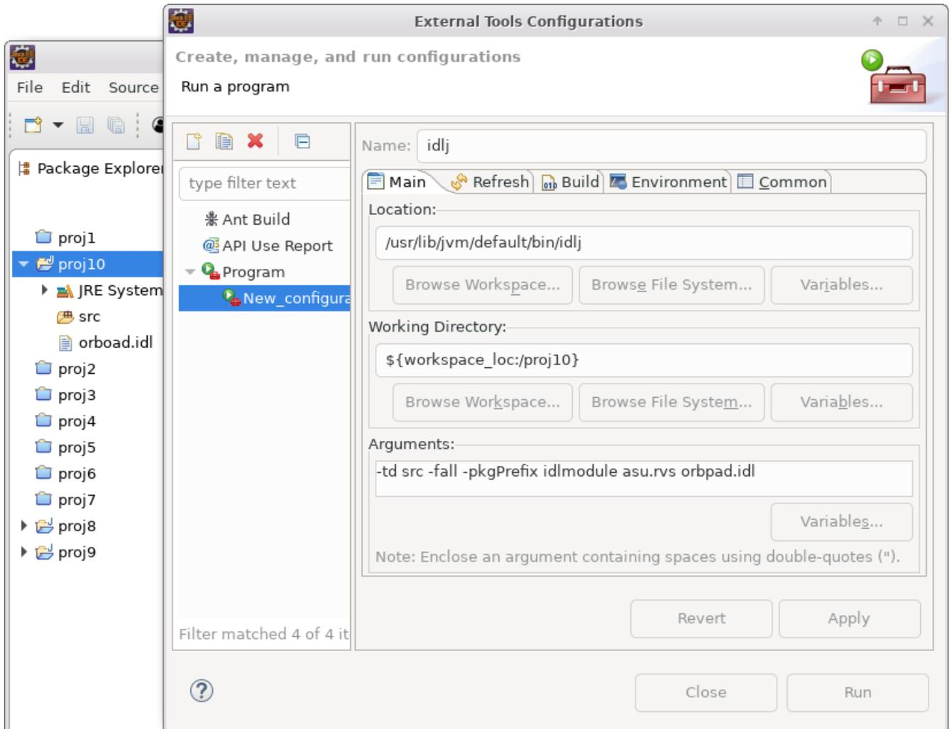
Рисунок 3.14 — Задание параметров вызова компилятора idlj
