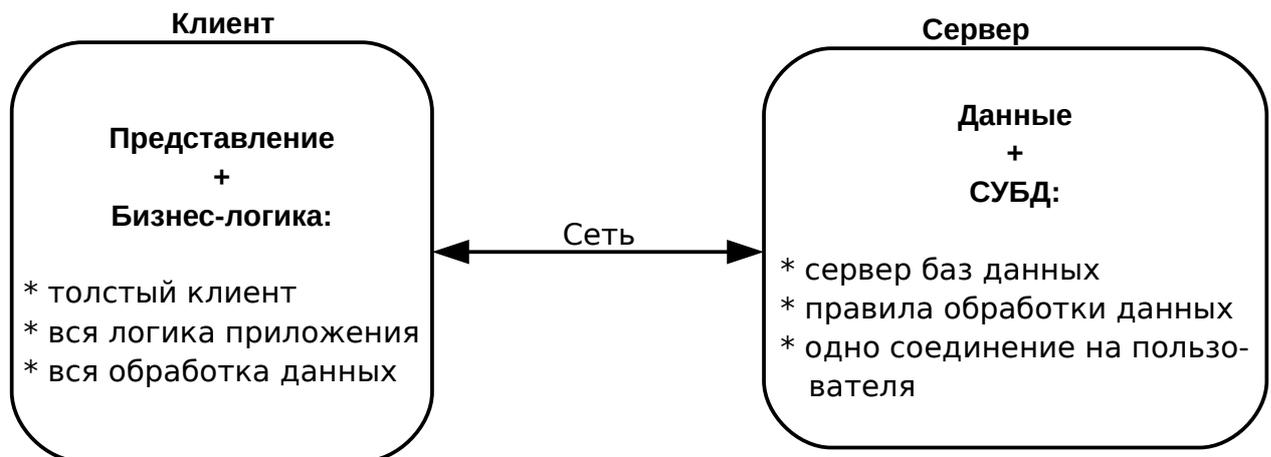
Рисунок 4.1 — Двухзвенная архитектура «Клиент-сервер»
