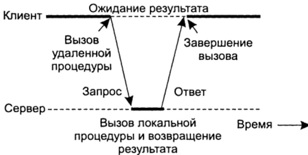
Рисунок 1.9 - Схема RPC между программами клиента и сервера (заимствовано из источника [3])
