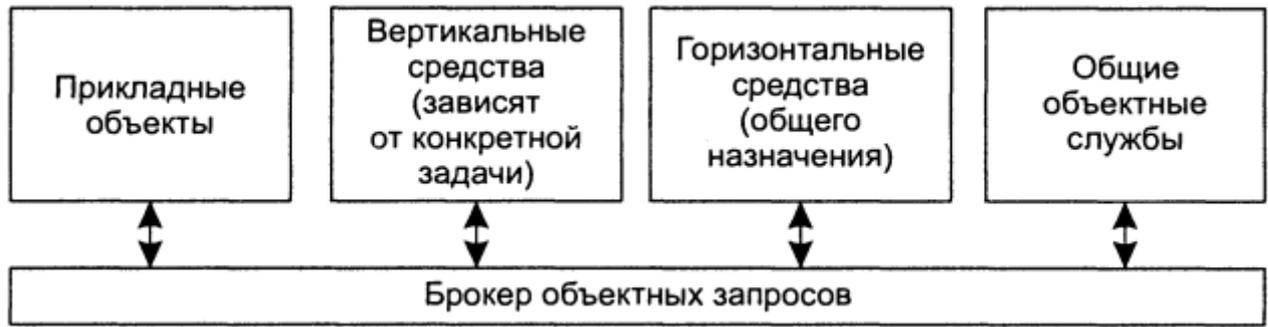
Рисунок 3.6 — Глобальная архитектура CORBA (заимствовано из источника [3])
