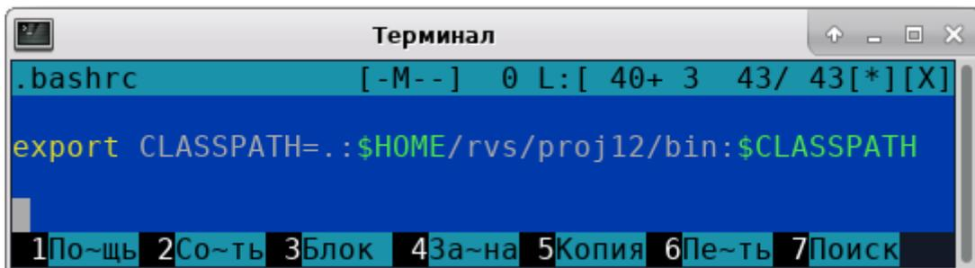
Рисунок 3.20 — Добавление пути в системную переменную CLASSPATH
