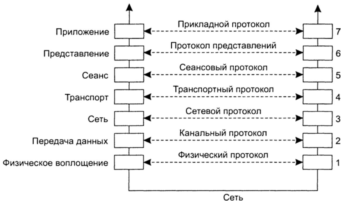
Рисунок 1.7 - Уровни, интерфейсы и протоколы модели OSI (заимствовано из источника [3])
