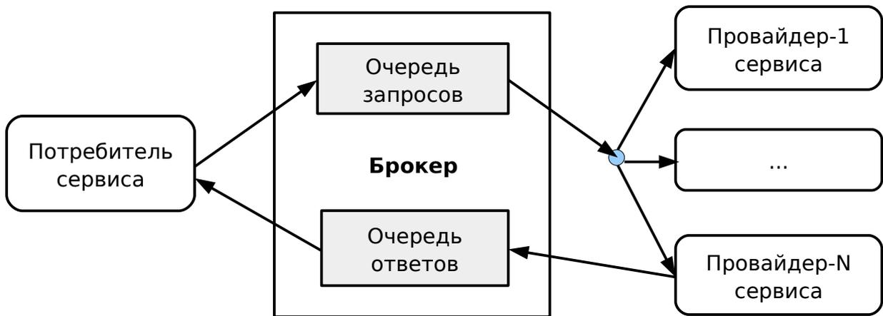
Рисунок 5.5 — Асинхронный вызов через посредника
