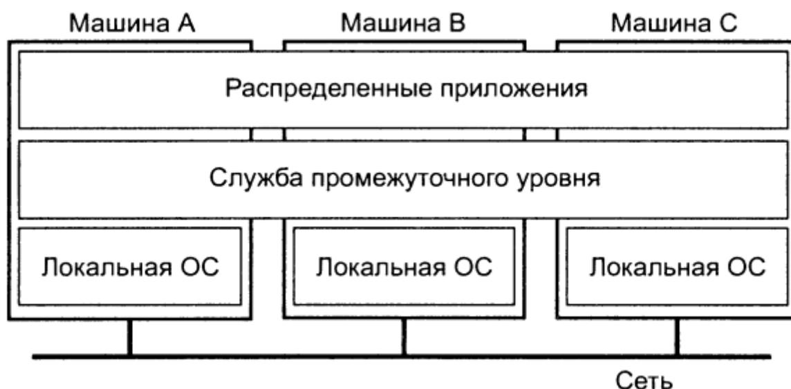
Рисунок 1.5 — Распределенная система (заимствовано из источника [3])
