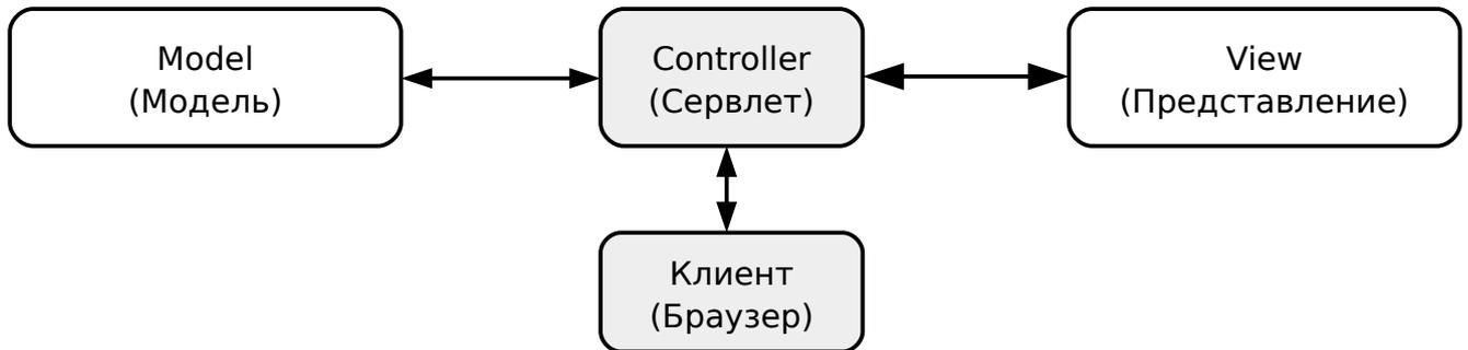
Рисунок 4.26 — Трехзвенная архитектура, реализуемая моделью MVC
