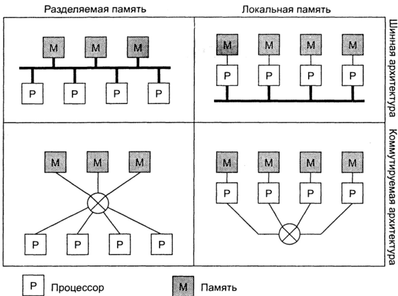
Рисунок 1.6 - Различные базовые архитектуры процессоров и памяти распределенных компьютерных систем (заимствовано из источника [3])
