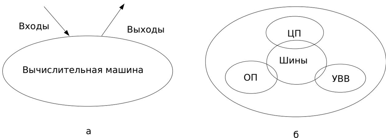
Рисунок 1.1 — Уровни детализации вычислительной машины (заимствовано из [2]): а — уровень «черного ящика»; б — уровень общей архитектуры
