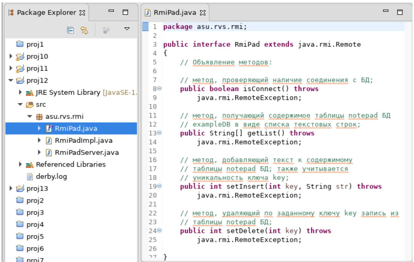
Рисунок 3.18 — Пример интерфейса удаленного объекта в технологии RMI
