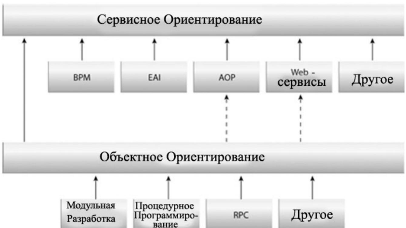
Рисунок 1.11 — Соотношение объектно-ориентированного и сервисного подходов в создании прикладных систем (заимствовано из источника [19])
