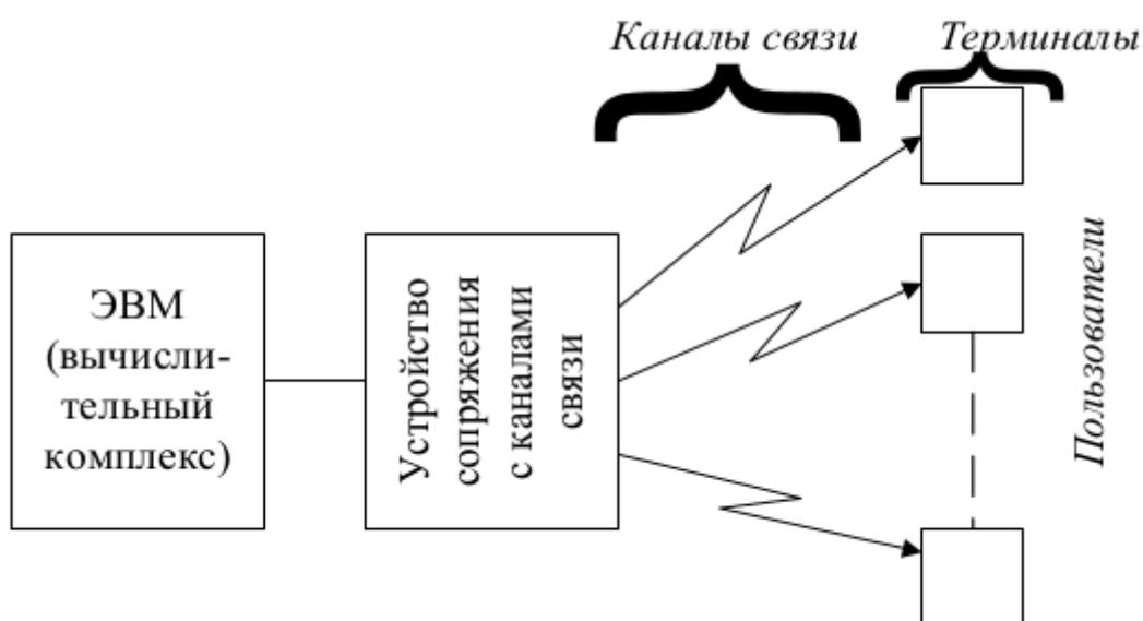
Рисунок 1.3 - Система телеобработки данных (заимствовано из источника [4])
