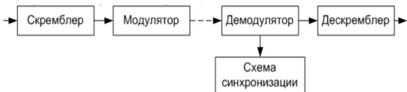
Рисунок 6.1 – Схема включения скремблера и дескремблера в канал связи
