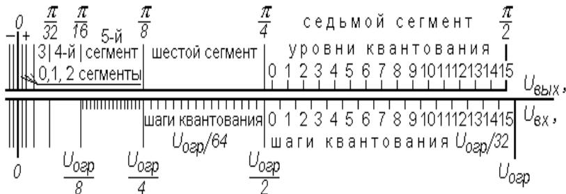
Рисунок 2.5 – Шкала непрерывного  $U_{вх}$  и квантованного  $U_{вых}$  напряжений
