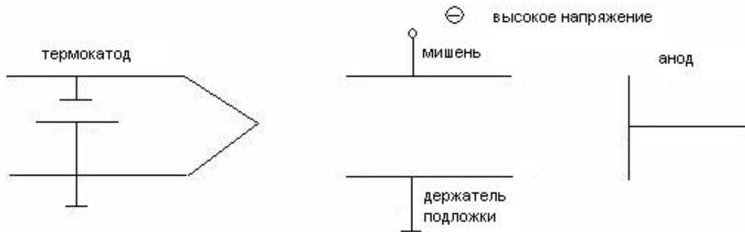
Рисунок 2.1 – Схема ионно-плазменного распыления
