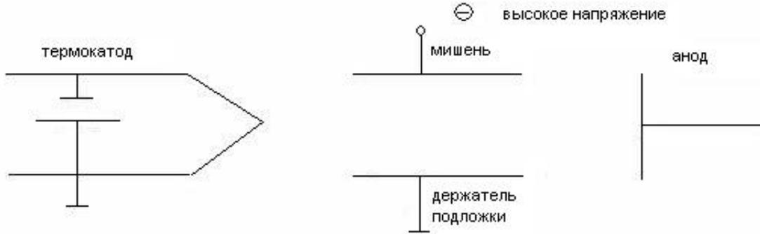
Рисунок 2.1 – Схема ионно-плазменного распыления
