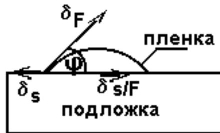
Рисунок 2.4 – Схема, поясняющая механизм формирования пленки
