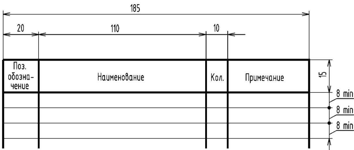
Рис. 28. Верхняя часть таблицы перечня элементов с размерами.
