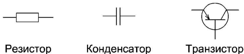
Рис. 26. Примеры трёх условных графических обозначений (УГО)
