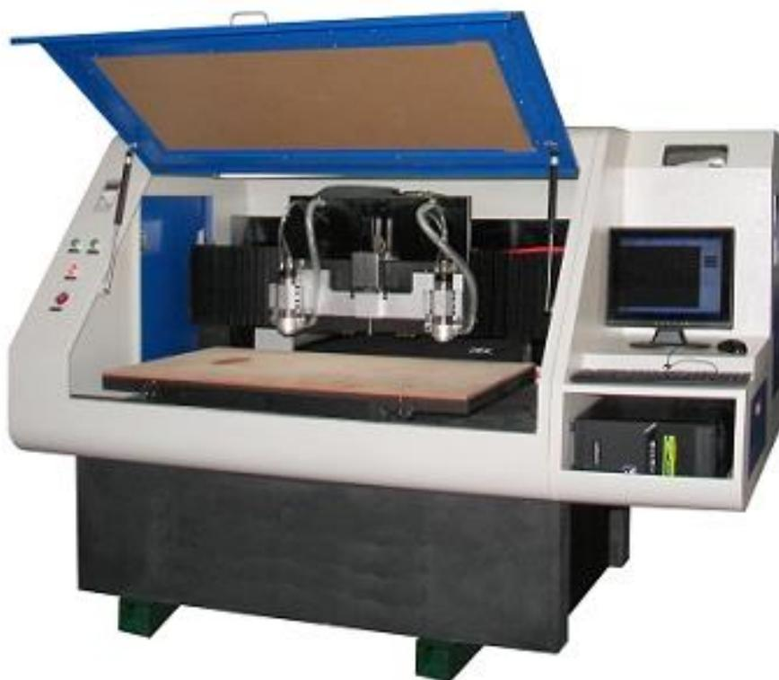
Рисунок 3.2 – Станок сверлильно-фрезерный с ЧПУ (двухшпindelный)
