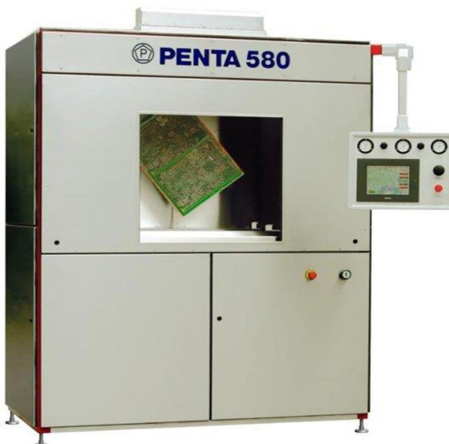
Рисунок 3.8 – Установка горячего лужения PENTA
