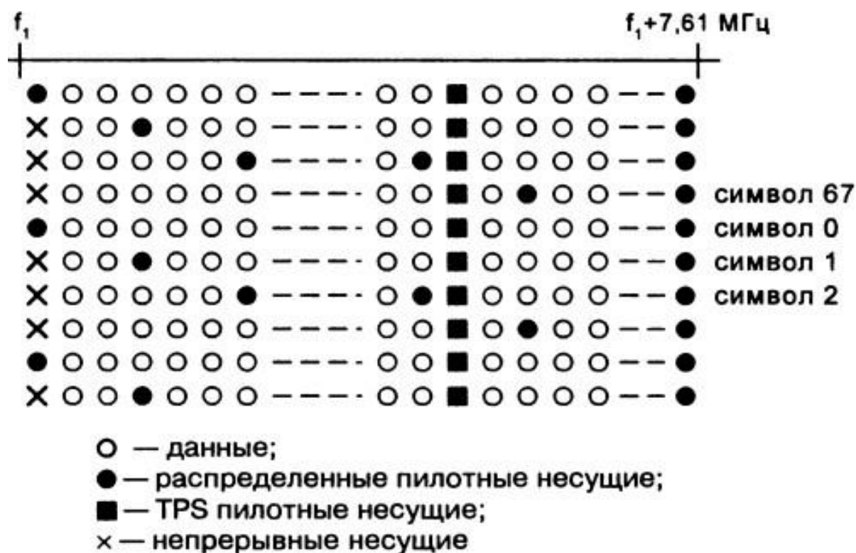
Рис. 203. Структурная схема формирователя OFDM-символа в системе DVB-T
