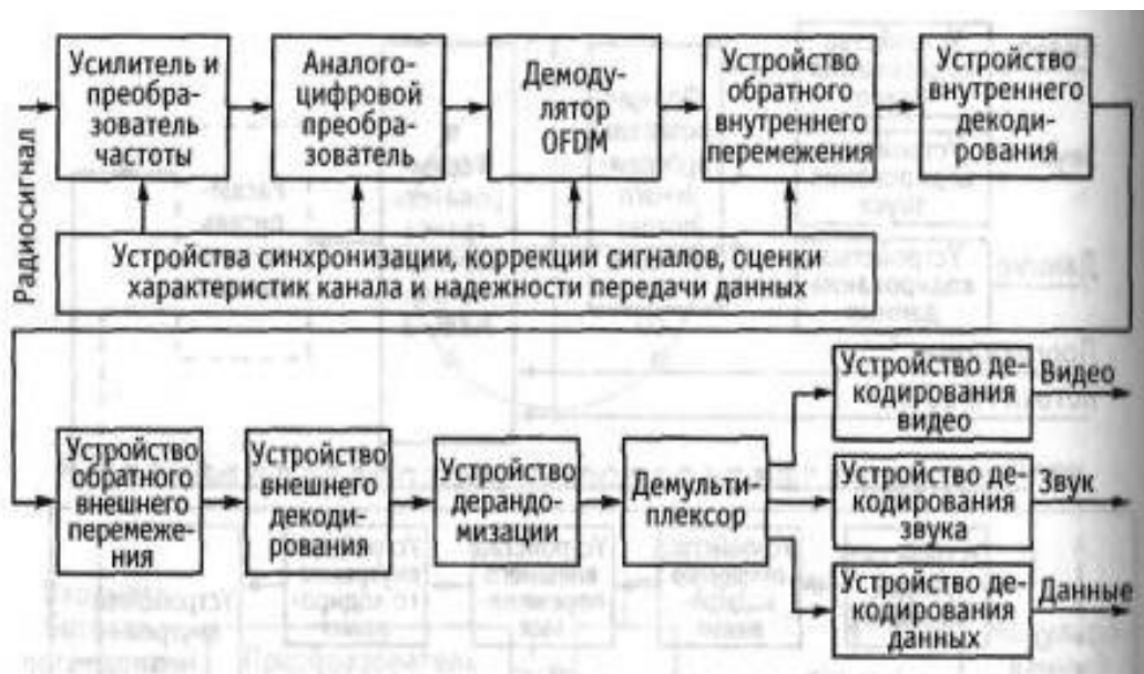
Рис. 184. Структурная схема приемника системы DVB-T
