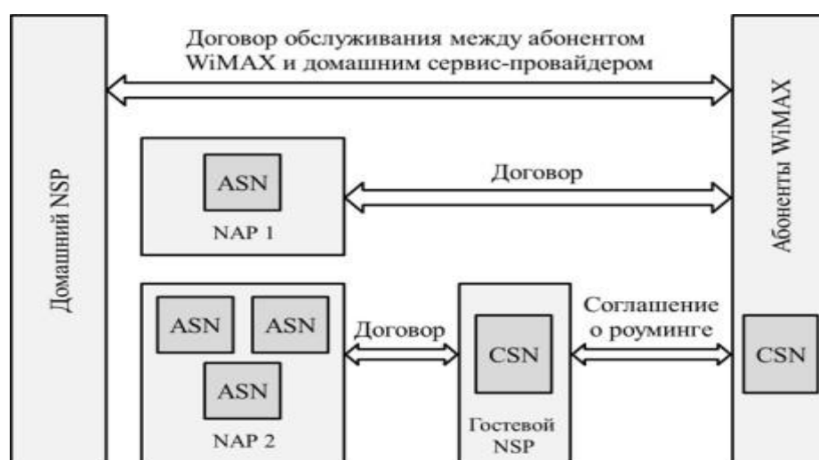
Рис. 101. Модель взаимодействия операторов сервисных сетей WiMAX IEEE 802.16, сетей доступа и абонентов
