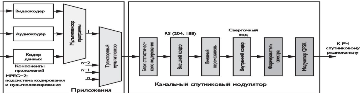
Рис. 201. Структурная схема передающей части системы DVB-S
