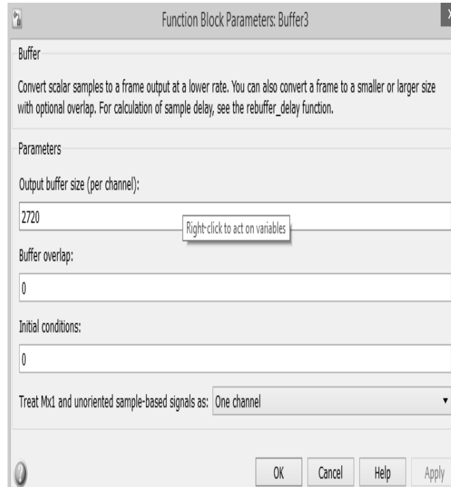
Рис. 229. Параметры DVB Inner Deinterleaver (Buffer3)
