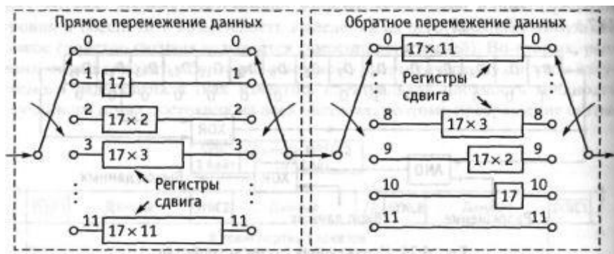
Рис. 187. Функциональная схема внутреннего перемежителя данных
