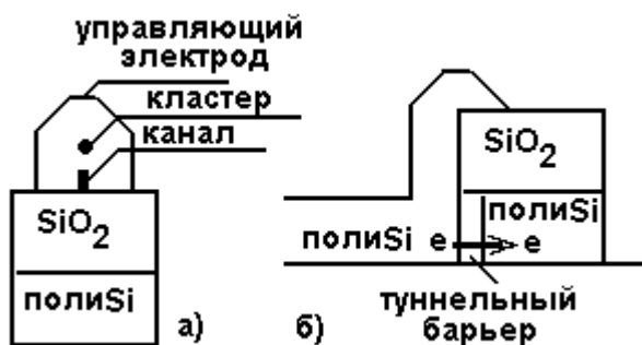
Рисунок 1.6 - а) схема формирования одноэлектронного устройства памяти, б) схема формирования одноэлектронного транзистора
