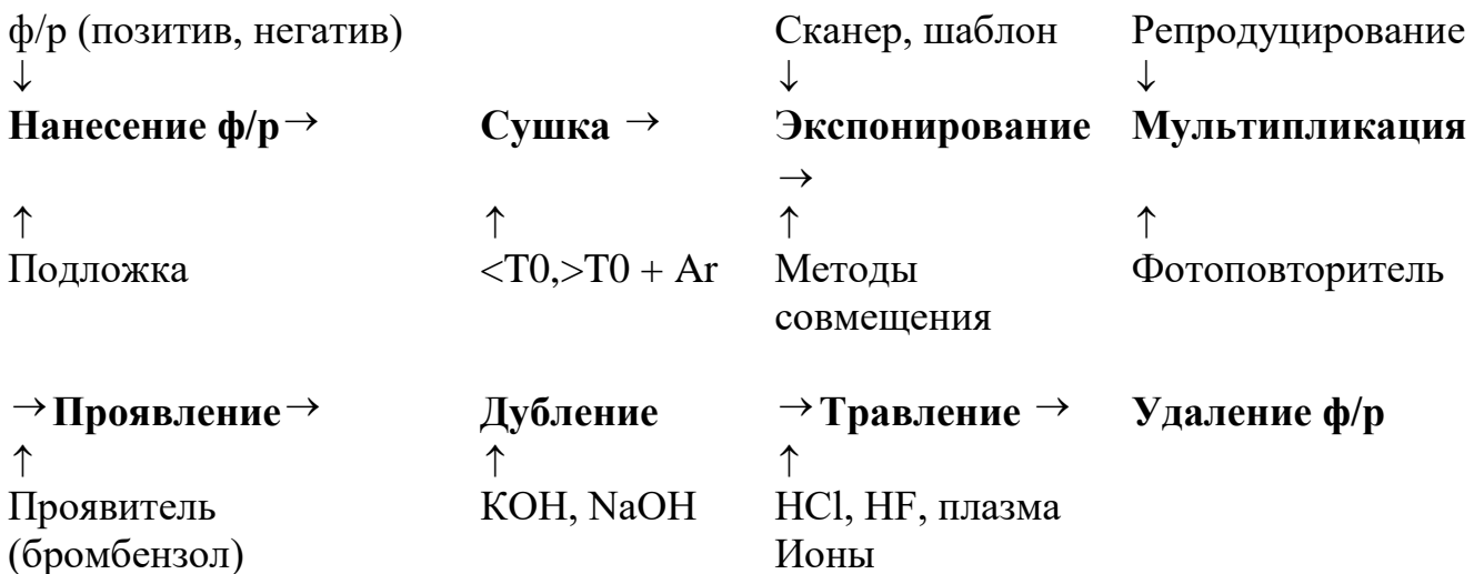
Рисунок 3.2 - Основные этапы типового литографического процесса
