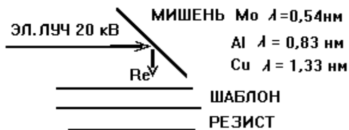
Рисунок 3.9 - Схема реализации рентгенолитографии
