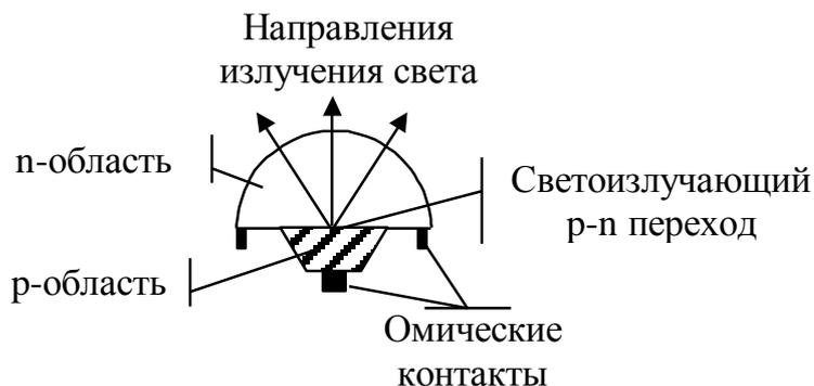
**Рисунок 5.13 – Конструкция ППЗСИ с полусферической n областью**
