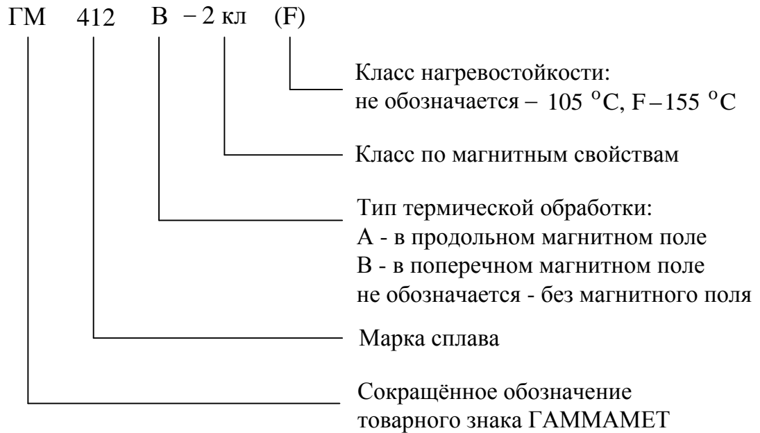
Рисунок 4.9 – Структура условного обозначения типа магнитопровода
