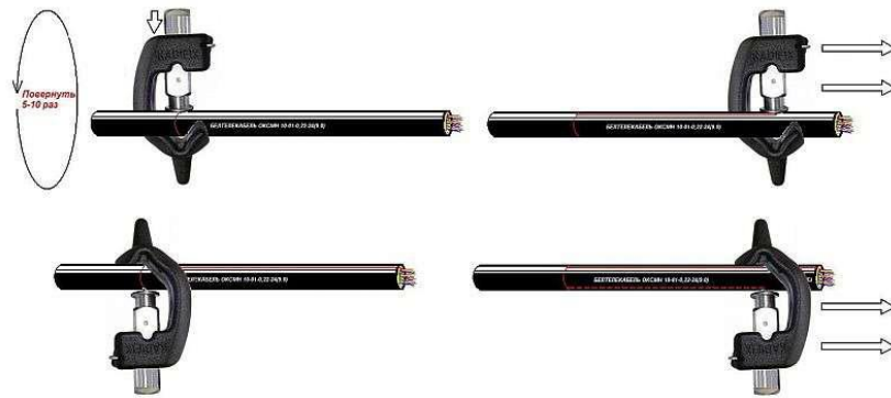
Рисунок 6 — Снятие внешней оболочки кабеля ножом-стриппером
