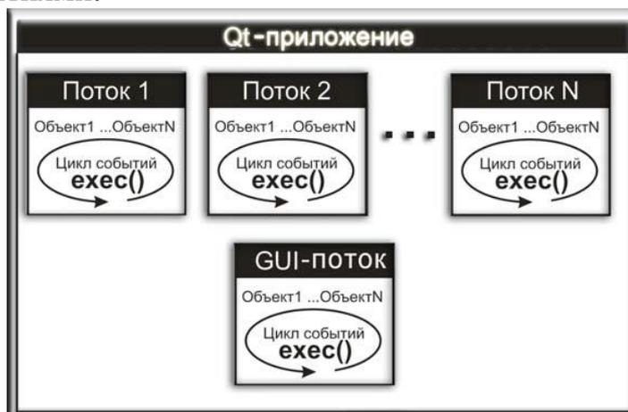
Рисунок 5.1 – Потоки с объектами и собственными циклами обработки информации
