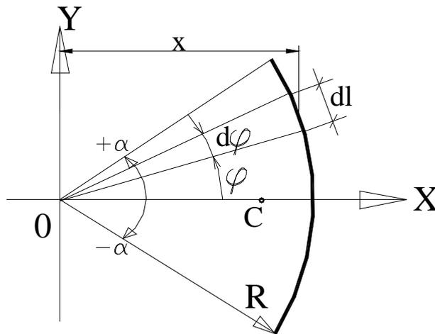
Рисунок 1.20 – Схема к определению центра тяжести дуги и сектора
