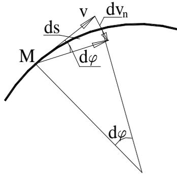
Рисунок 2.7 – Определение кривизны траектории
