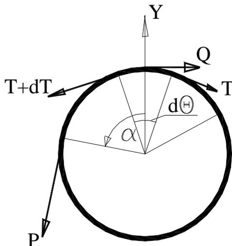
Рисунок 1.14 – Схема к задаче о трении нити о цилиндрическую поверхность
