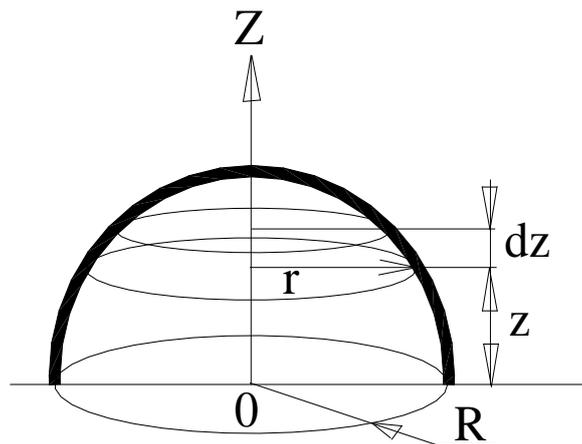
Рисунок 1.21 – Определение центра тяжести полушара
