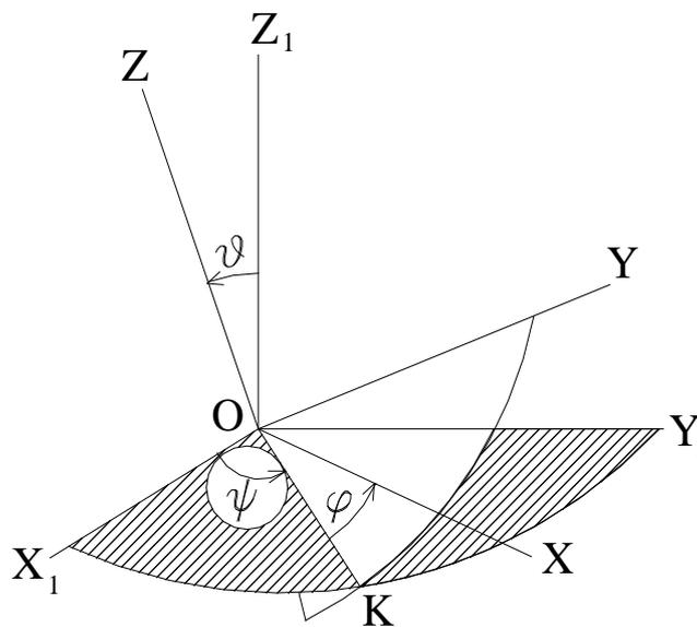
Рисунок 2.25 – Углы, определяющие положение тела
