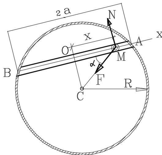
Рисунок 3.2 – Схема к задаче о движении материальной точки по каналу
