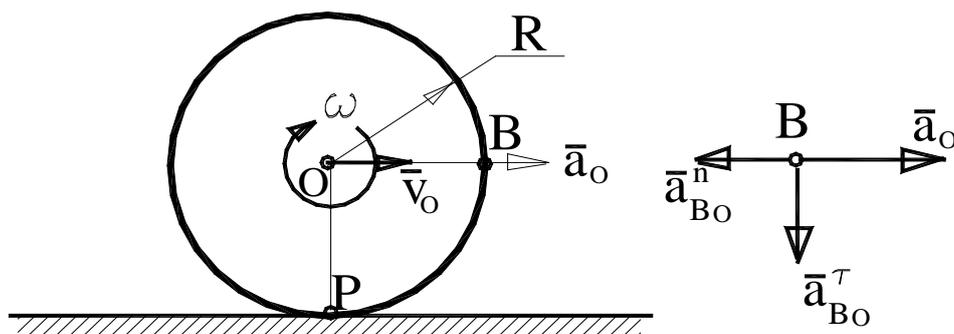
Рисунок 2.23 – К определению ускорений точек колеса
