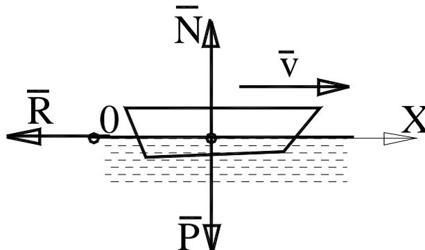
Рисунок 3.3 – Схема к задаче о движении лодки
