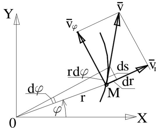
Рисунок 2.9 – Движение точки в полярных координатах
