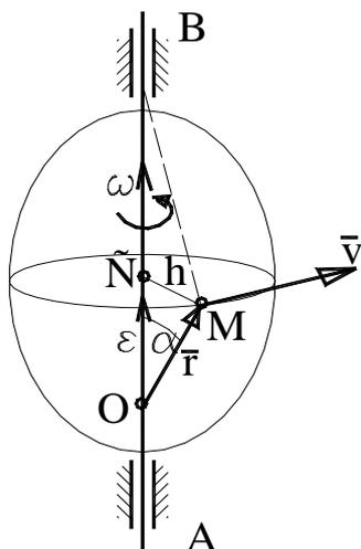
Рисунок 2.12 – Определение вектора скорости точки вращающегося тела
