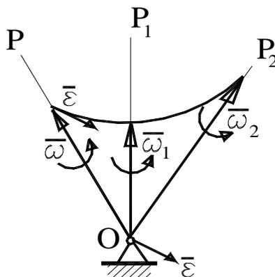
Рисунок 2.27 – Сложение угловых ускорений
