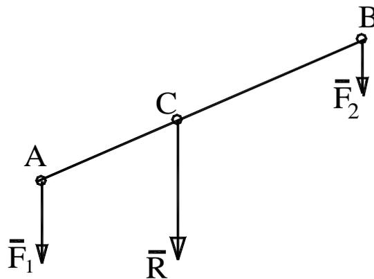
Рисунок 1.19 – Определение равнодействующей для двух параллельных сил
