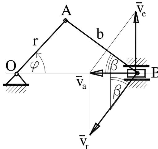
Рисунок 2.31 –  $OA$  – кривошип,  $AB$  – шатун,  $B$  – ползун
