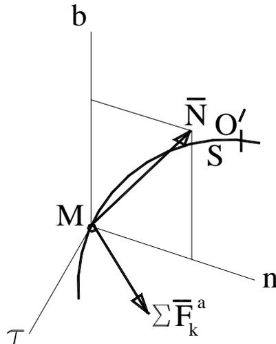
Рисунок 3.15 – Схема движения точки вдоль гладкой кривой
