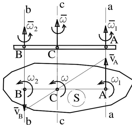
Рисунок 2.34 – Сложение однонаправленных параллельных вращений
