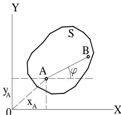
Рисунок 2.14 – Степени свободы тела при плоском движении
