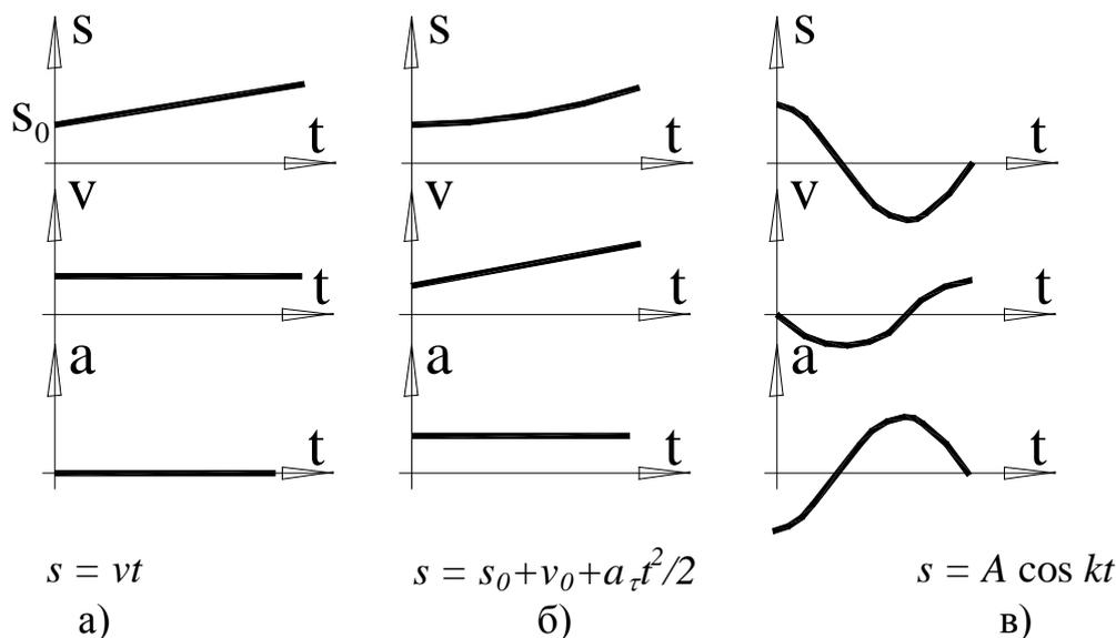
Рисунок 2.8 – Графики положения, скорости и ускорения точки в зависимости от времени
