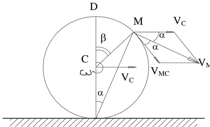
Рисунок 2.17 – Определение скорости точки на ободе колеса
