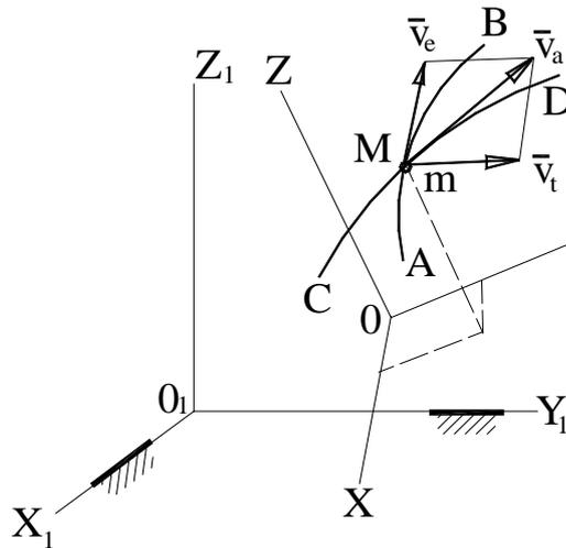
Рисунок 2.28 – К определению абсолютного, переносного
