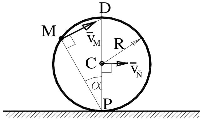
Рисунок 2.21 – Схема к задаче об определении скорости точки на ободе
