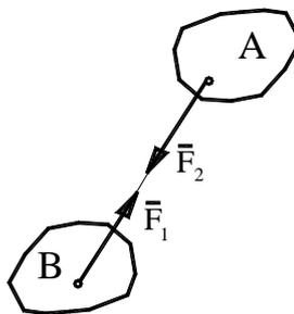
Рисунок 1.4 – К закону равенства действия и противодействия
