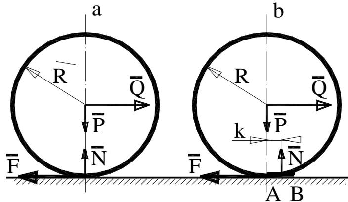
Рисунок 1.15 – Идеальная (а) и реальная (б) схемы взаимодействия катящегося круглого цилиндра с горизонтальной опорой
