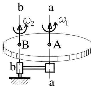
Рисунок 2.33 – Сложение параллельных вращений
