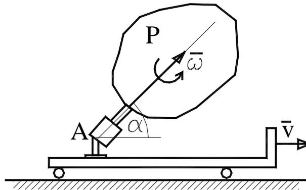
Рисунок 2.37 – Сложение поступательного и вращательного движения
