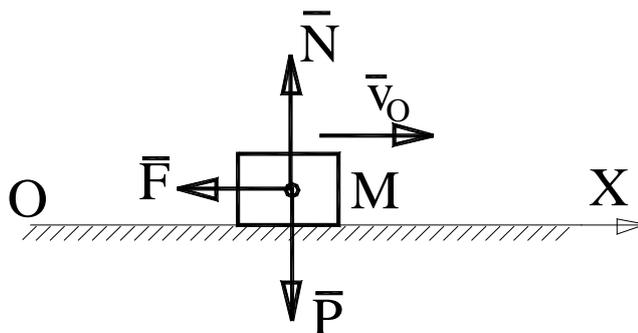
Рисунок 3.5 – К задаче о движении тела по шероховатой поверхности
