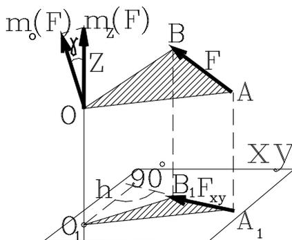
Рисунок 1.16 – К определению момента относительно оси
