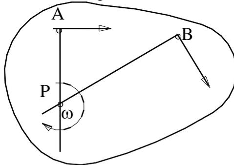
Рисунок 2.19 – Определение мгновенного центра скоростей
