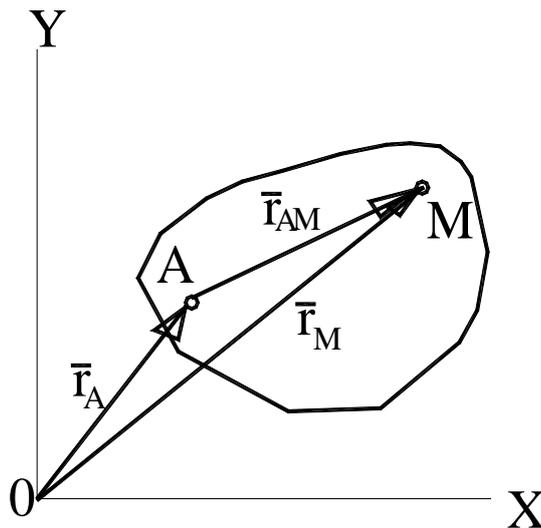
Рисунок 2.22 – Определение ускорения произвольной точки
