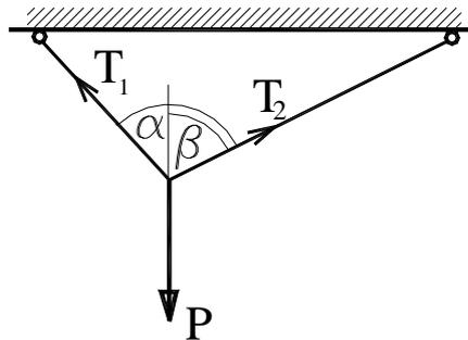
Рисунок 1.12 – Пример статически определимой системы
