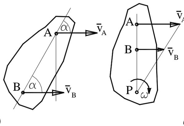
Рисунок 2.20 – Определение мгновенного центра скоростей
