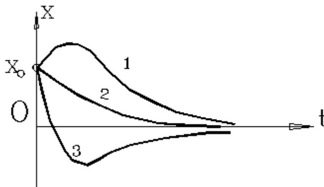
Рисунок 3.21 – Аperiodическое движение при большом вязком сопротивлении
