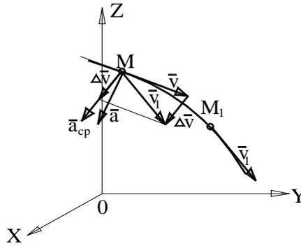
Рисунок 2.4 – К определению ускорения
