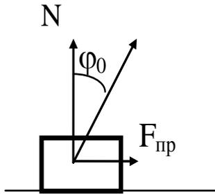
Рисунок 1.13 – К определению угла трения
