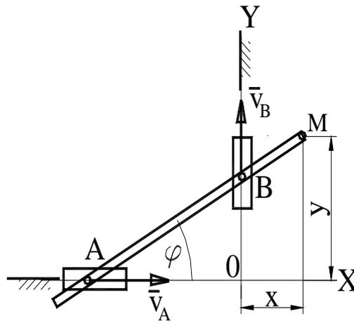
Рисунок 2.16 – Схема эллипсографа
