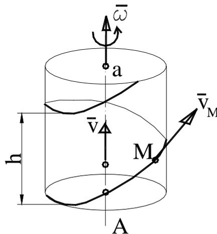
Рисунок 2.38 – Винтовое движение
