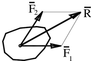
Рисунок 1.3 – Суммирование сил по правилу параллелограмма
