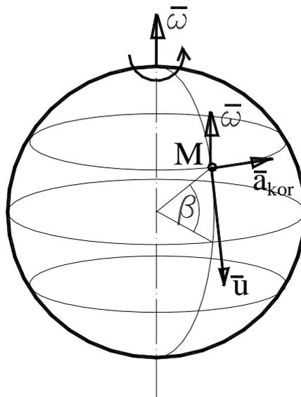
Рисунок 2.32 – Схема движения точки вдоль меридиана
