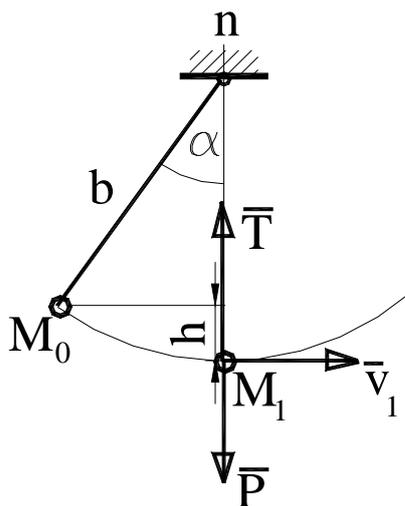
Рисунок 3.17 – К задаче об определении натяжения нити
