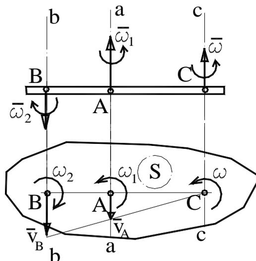
Рисунок 2.35 – Сложение разнонаправленных параллельных вращений
