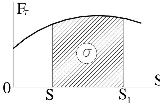
Рисунок 3.9 – Работа сил
