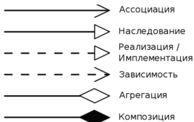
Рис. 4. Обозначение типов взаимодействия классов в языке UML
