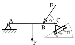
3. Вес Р балки AB, шарнирно закрепленной в точке A, составляет 200 H. Определить вес груза R удерживающего балку в положении, указанном на схеме. В точке B к балке подвешен груз Q. Найти решение при  $\alpha=30^{0},\,\beta=45^{0},\,Q=200\,\text{H}.$
