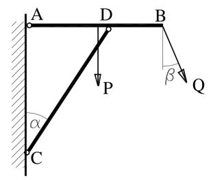
3. Найти реакции опор  $R_A$ ,  $R_B$ , если к балке приложены нагрузки, показанные на схеме. Учесть вес P однородной балки AC.
