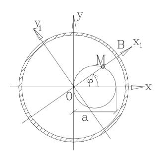
скоростью по закону  $\varphi = kt$ . По стреле крана ОВ движется тележка M в соответствии с уравнением  $x = a \cdot coskt$ . Определить уравнение абсолютного движения точки M и ее траекторию.
