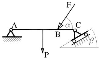
2. Найти реакции в узлах A, C при заданных  $\alpha$ ,  $\beta$ , P, Q, AB, BD. Определить реакции при  $\alpha = 45^{\circ}$ ,  $\beta = 30^{\circ}$ , P = 120 H, Q = 60 H, AB = 1.5 м, BD = 40 см.
