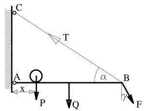
2. Найти реакции опор A и C балки весом P, на которую действует в точке B сосредоточенная сила F под углом  $\alpha$ . Расположение опор показано на схеме. Найти решение при AB = 3 м, AC = 4 м, P = 100 H, F = 75 H,  $\alpha$  =  $60^{\circ}$ ,  $\beta$  =  $30^{\circ}$ .
