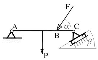
2. Найти значение силы F, при котором груз P на наклонной плоскости будет в равновесии, если коэффициент трения скольжения груза по наклонной плоскости равен k. Способ приложения силы показан на схеме.
