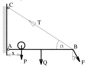
2. Найти реакции опор A и C балки весом P, на которую действует в точке B сосредоточенная сила F под углом  $\alpha$ . Расположение опор показано на схеме. Найти решение при AB = 6 м, AC = 10 м, P = 1500 H, F = 750 H,  $\alpha$  = 45 $^{0}$ ,  $\beta$  = 30 $^{0}$ .
