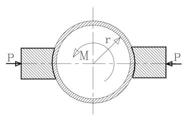
Для равновесия необходимо, чтобы сумма моментов, приложенных к барабану, равнялась нулю. Силы трения F- из-за симметрии — образуют пару, момент которой можно определить как  $2 \cdot F \cdot r$ , причем сила трения определяется через прижимающую силе P по формуле для сил трения скольжения
