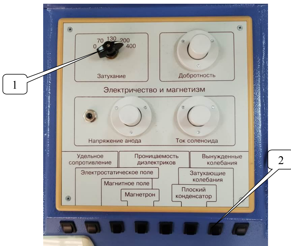
Рисунок 4.3 – Панель выбора работы:
