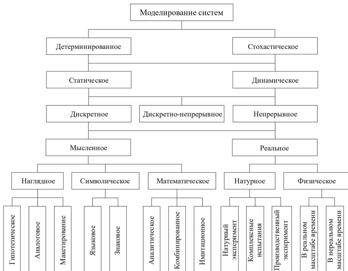
Рис. 1.1 – Классификация видов моделирования систем
