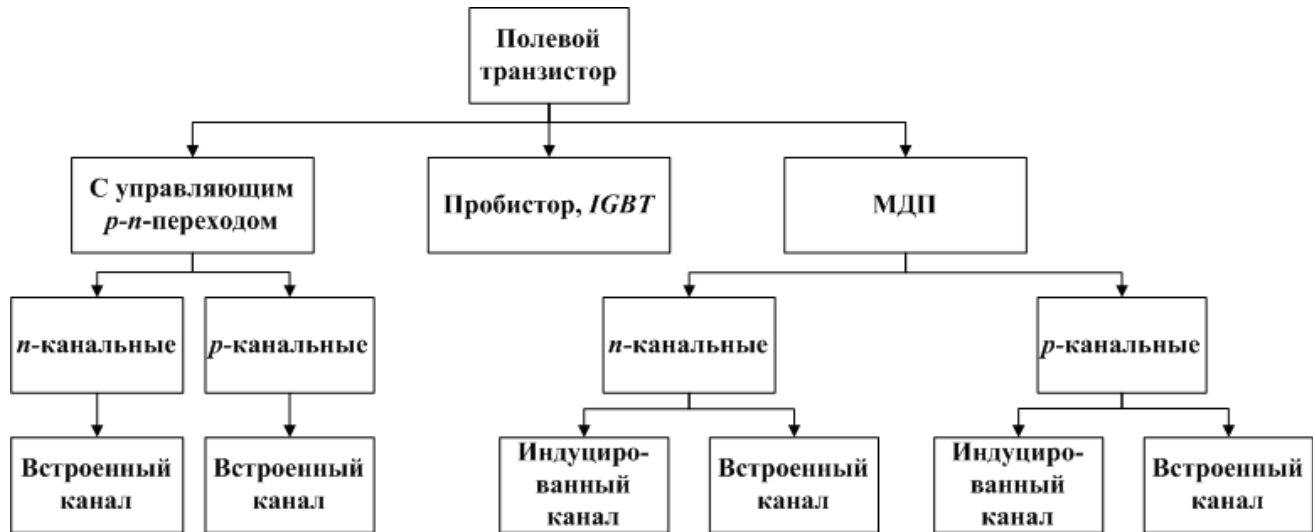
Рисунок 2.2 – Схема классификации полевых транзисторов
