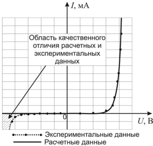
Рисунок 2.20 – ВАХ светоизлучающего диода
