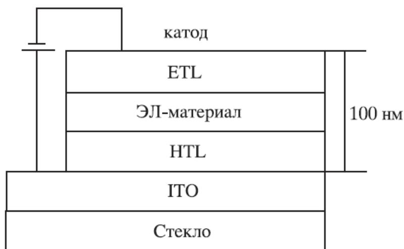
Рисунок 4.18 – Базовая структура ОСИД:
