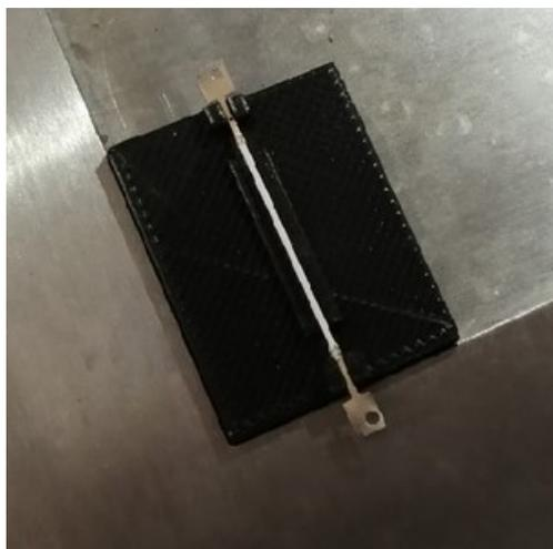
Рисунок 4.6 – Фотография керамического основания, помещённого в специальную подставку
