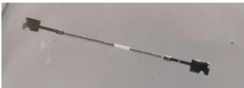
Рисунок 4.9 – Фотография напечатанных дорожек на керамическом основании
