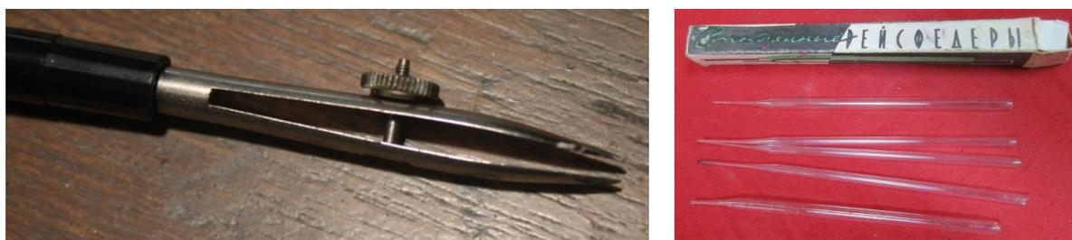
Рисунок 1.2 – Фотографии металлического (а) и стеклянных (б) рейсфедеров
