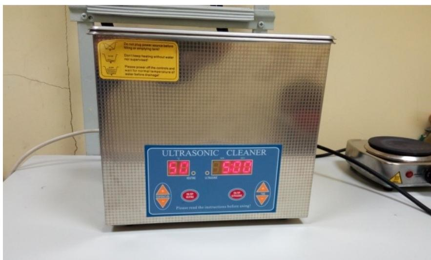
Рисунок 2.2 – Установка для промывки в ультразвуковой ванне
