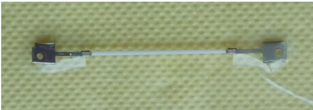
Рисунок 3.17 – Фотография керамической подложки с металлическими наконечниками по краям
