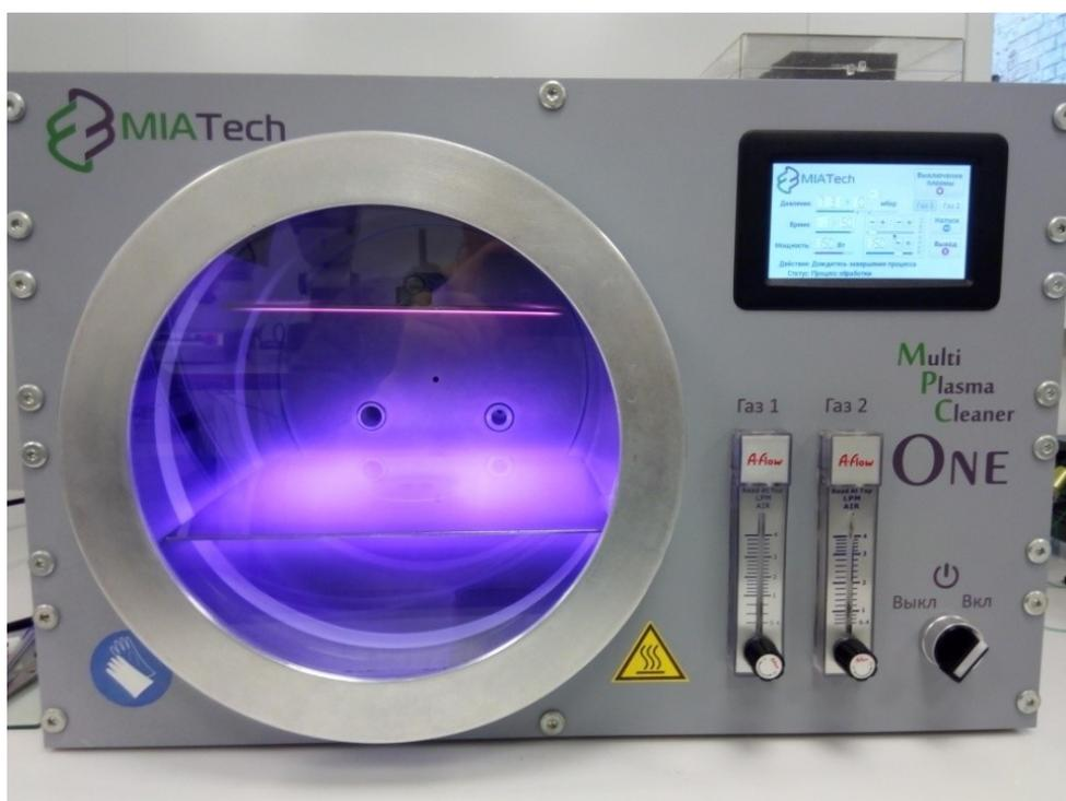
Рисунок 2.3– Установка плазменной очистки
