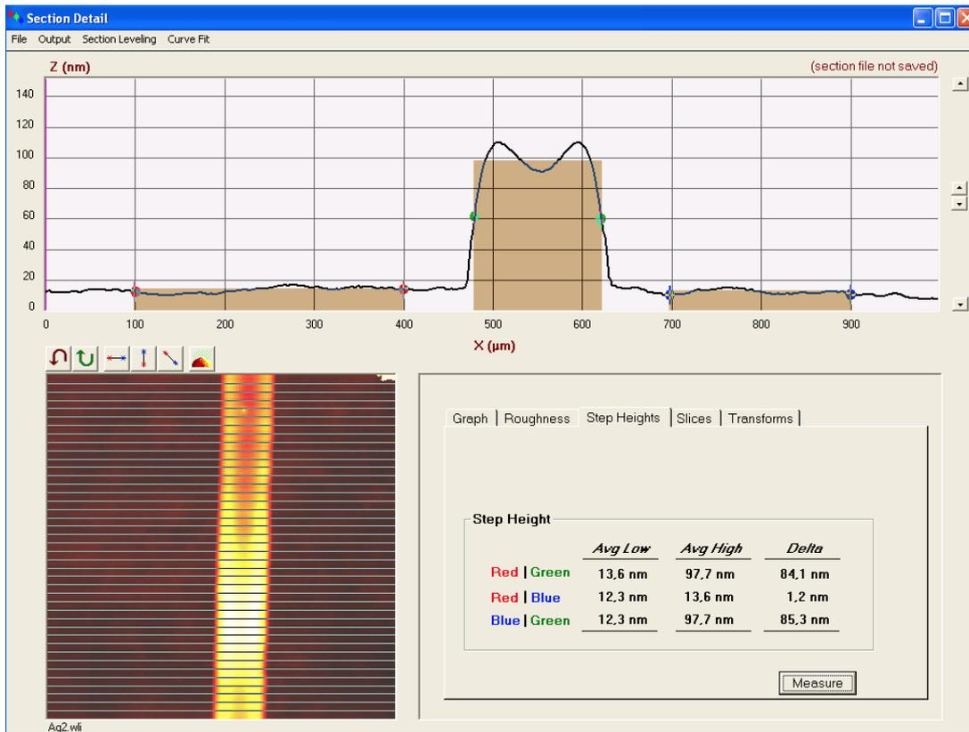
Рисунок 4.34 – Профилограмма проводящей пленки линии
