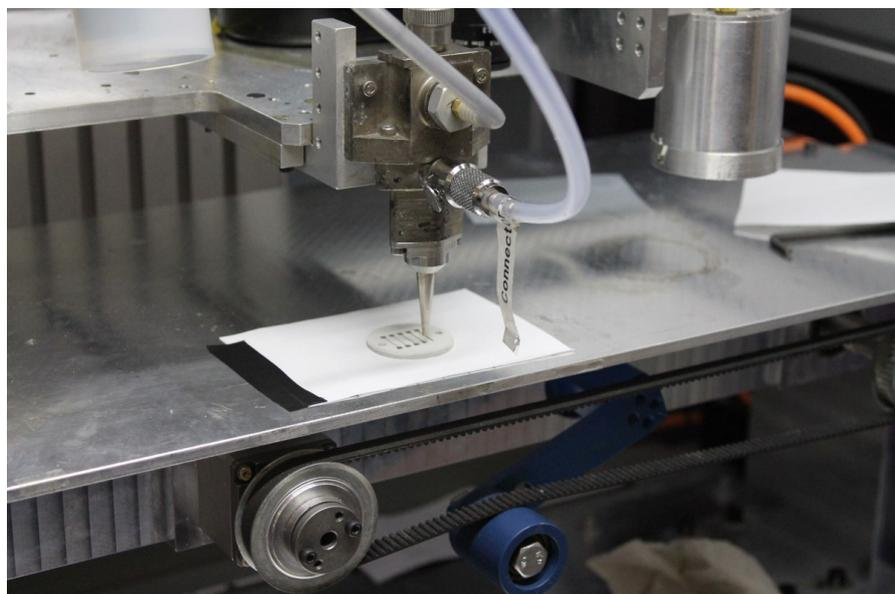
Рисунок 5.7 – Фотография печатающей головки аэрозольного принтера в процессе нанесения топологии
