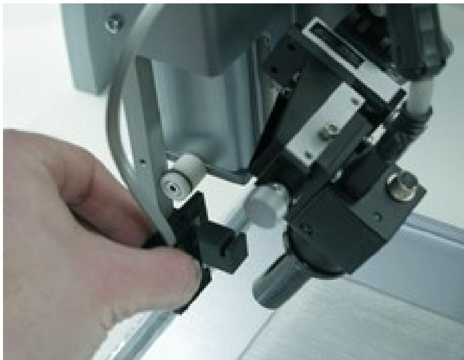
Рисунок 4.7 – Фотография загрузки картриджа диспенсера
