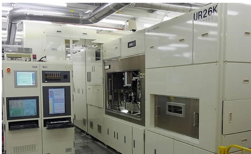
Рисунок 3.3 – Установка MOCVD эпитаксии Taiyo Nippon Sanso TNSC UR26K MOCVD
