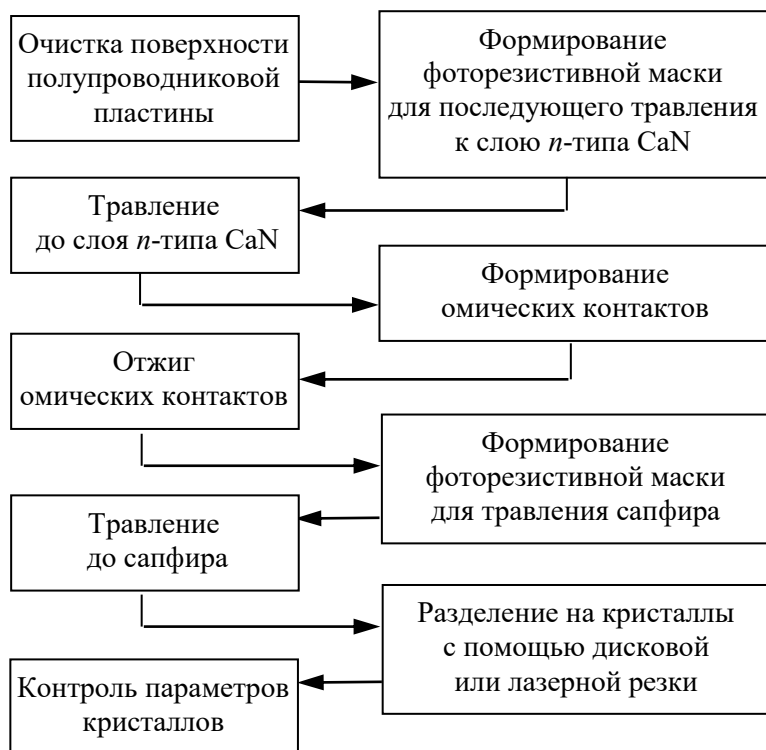
Рисунок 3.5 – Технологический процесс изготовления светодионного кристалла
