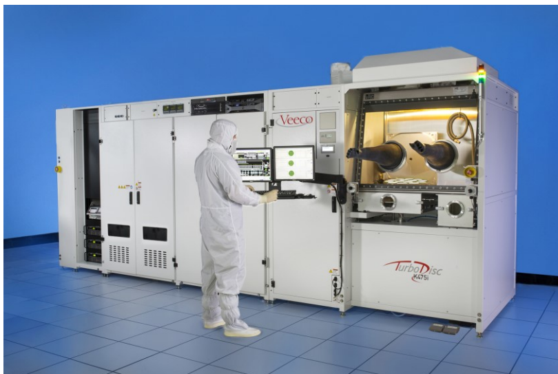
Рисунок 3.2 – Установка MOCVD эпитаксии Veeco
