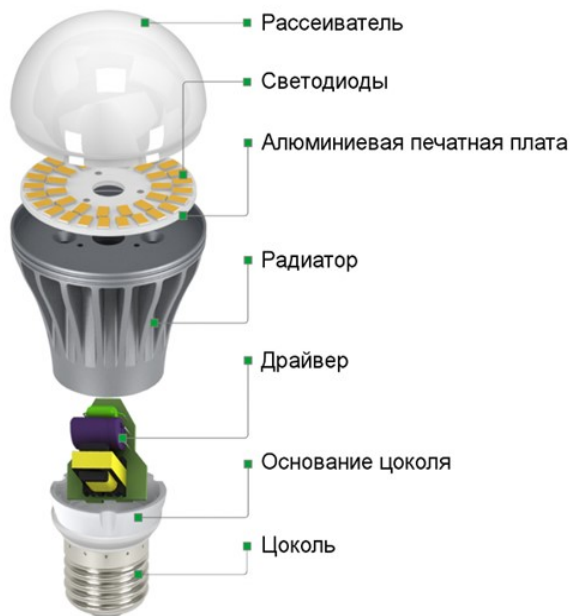
Рисунок 5.1 – Составные части светодиодной лампы
