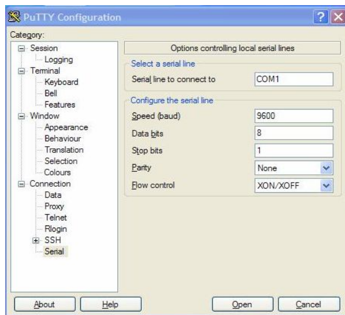
Рис. 2.3 — Базовая настройка для подключения к маршрутизатору
