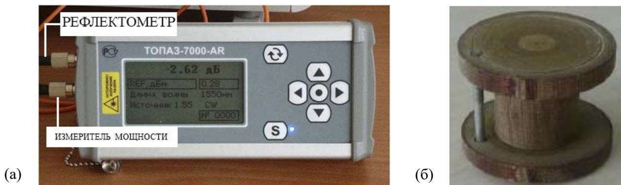
Рисунок 2.3 – Оптический рефлектометр «Топаз-7315-AR» (а) и модовый скремблер (б)
