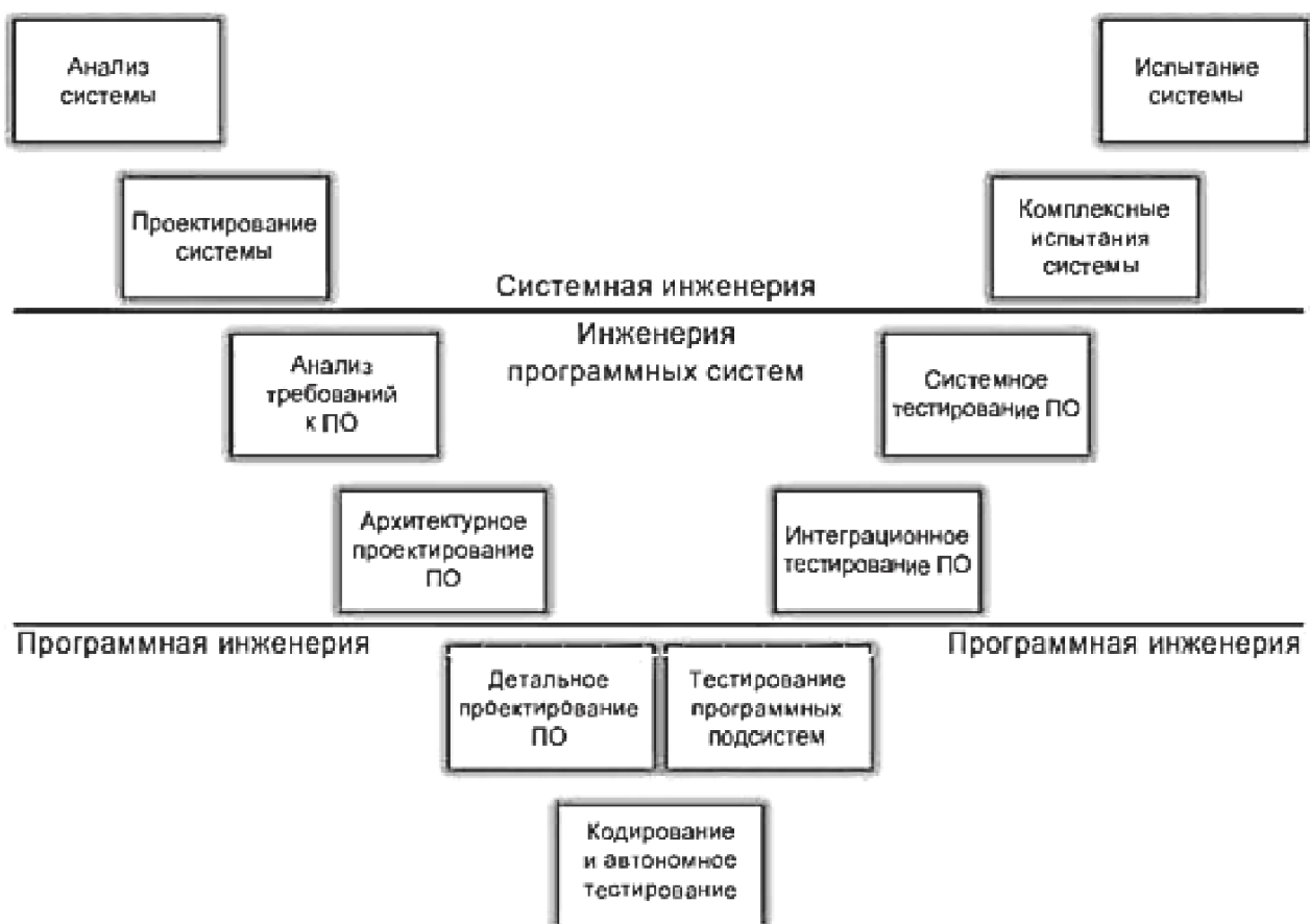
Рисунок 34 — Процесс инженерии программных систем согласно IEEE
