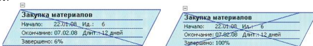
Рисунок – 2.9 Обозначение начатых и завершённых задач на сетевом графике
