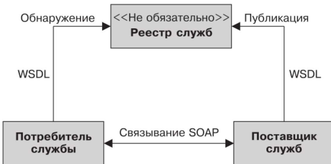
Рисунок 5.1 — Общая архитектура взаимодействия базовых составляющих сервис-ориентированных систем [17]
