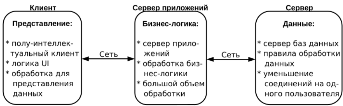
Рисунок 2.6 — Трехзвенная архитектура «Клиент-сервер» [1]
