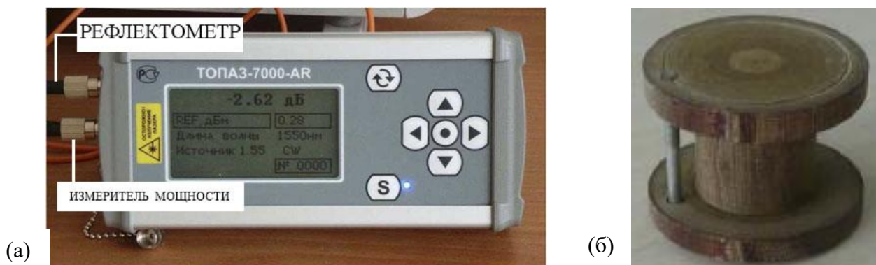
Рисунок 1.2.3 – Оптический тестер-рефлектометр «Топаз-7315-AR» (а) и модовый скремблер (б)
