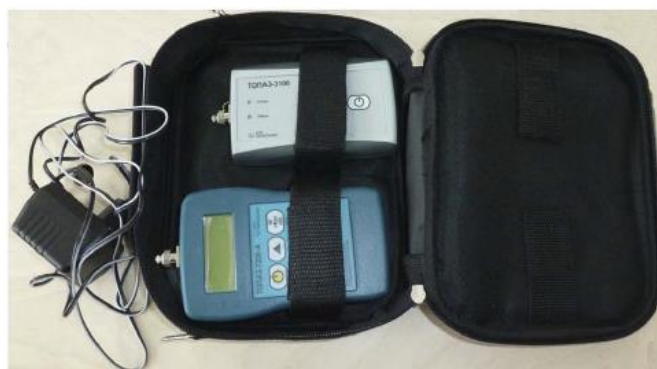
Рисунок 3.6 – Кейс с источником оптического излучения «Топаз 3105», измерителем оптической мощности «Топаз 7210А» и блоком питания «Топаз 7210А»
