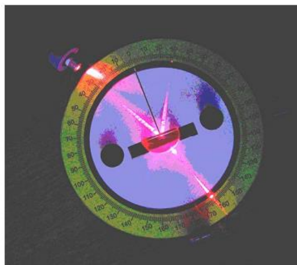
Рисунок 3.2 – Демонстрация закона Снеллиуса-Декарта с помощью прибора Гартля
