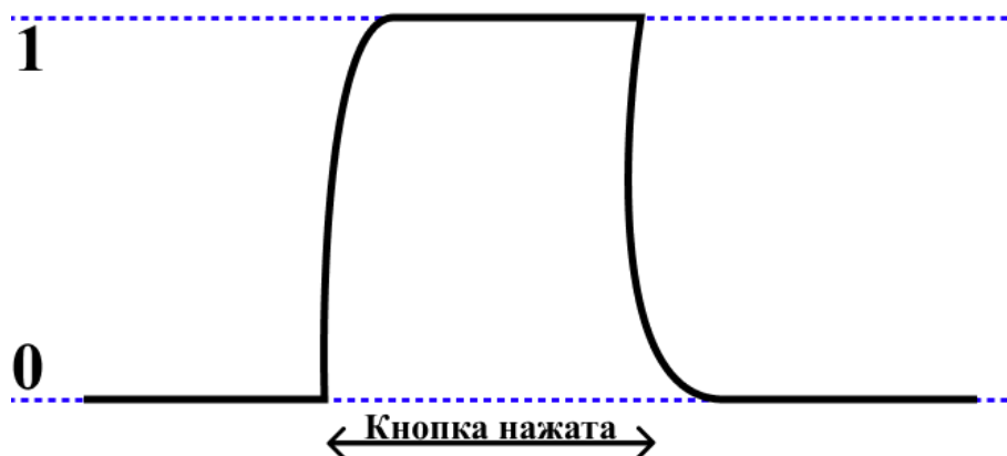
Рисунок 10.6 – Сигнал, принятый с кнопки при использовании фильтра
