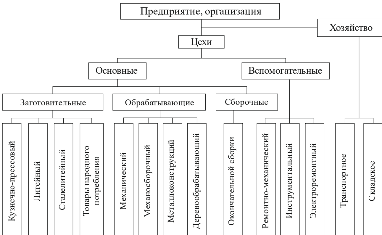
Рис. 3.12 – Типовая структура производства
