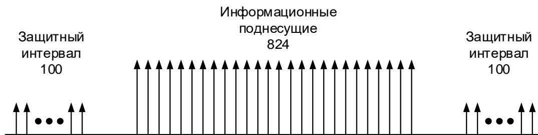
Рисунок 4.4 – Расположение поднесущих в OFDM символе
