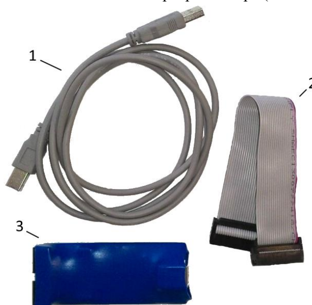
Рисунок 4.7 – Программатор MT-Link: 1 – кабель USB; 2 – шлейф программатора; 3 – программатор MT-Link.
