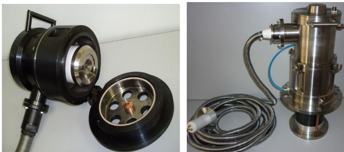
Рисунок 3.15 – Пушка с плазменным катодом 30 кВ (слева) и пушка с плазменным катодом 60 кВ (справа)
