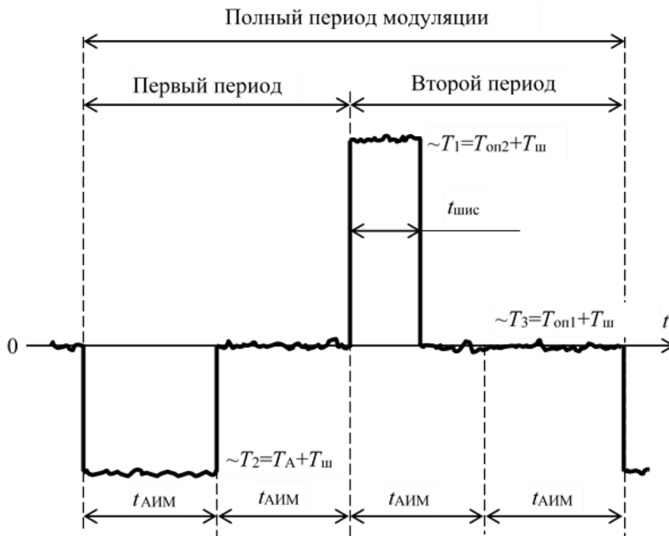
Рисунок 5.9 – Временная диаграмма одного периода модуляции в радиометре с широким динамическим диапазоном, регистрируемая на входе компаратора низкочастотного тракта
