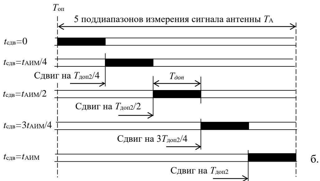
Рисунок 5.7 – Временная диаграмма одного периода модуляции при измерении сигналов T_A > T_{\text{оп}} (а) и карта диапазонов измерения (б).
