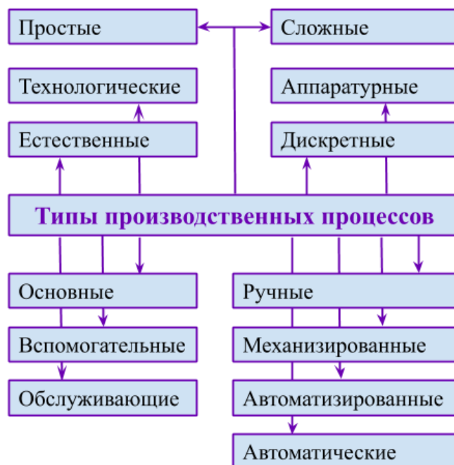
Рисунок 1.7. Классификация технологических процессов по роли в общем процессе изготовления продукции
