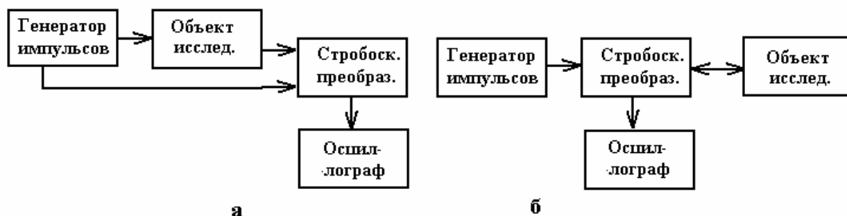
Рисунок 29. Структурные схемы исследования объектов: а – коэффициента передачи, б – коэффициента отражения.
