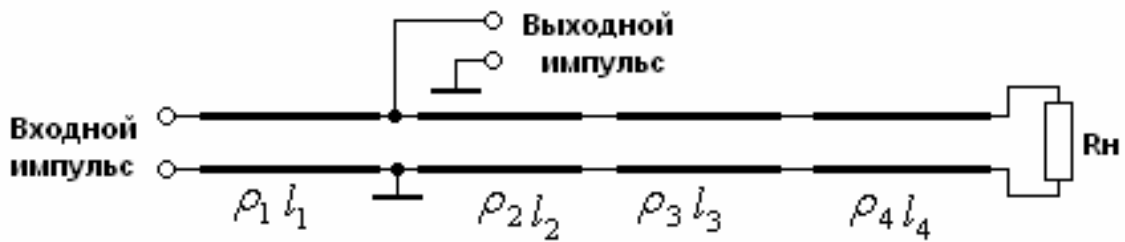
Рисунок 86. схема формирующей цепи на отрезках линии передачи
