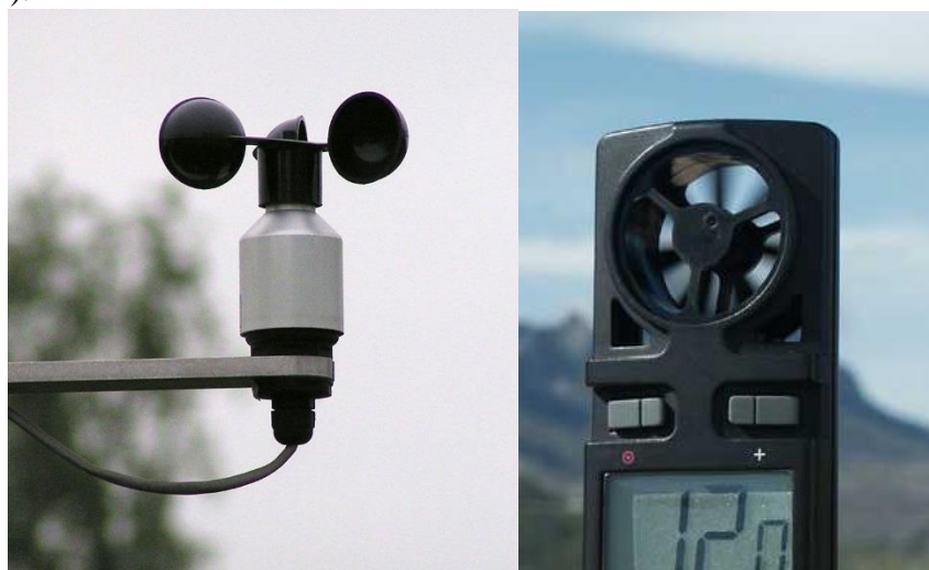
А Б Рисунок 4 – Анемометры: А – чашечный, Б – крыльчатый
