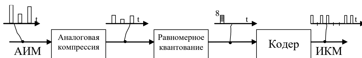
Рисунок 4.14 – Принцип аналогового компандирования
